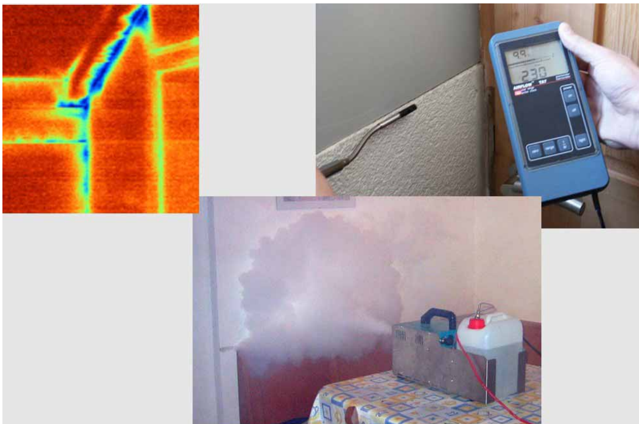
Analisi e test di tenuta all'aria - Gunter Gantioler-TBZ – Technisches Bauphysik Zentrum – Bolzano
