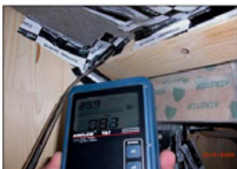
Rif. 5 Locale: Matrimoniale SOPPALCO Perdita: sigillatura telo soffitto 0,81 m/s
