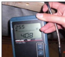
Rif. 6 Locale: Matrimoniale SOPPALCO Perdita: sigillatura telo-soffitto 4,08
